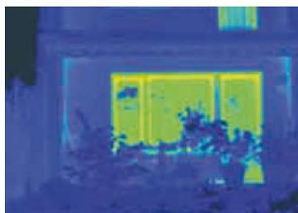
Infrarot-Aufnahme Fenster und Verglasung von OLIVA. Hier erkennt man deutlich den hohen energetischen Vorteil der Investition. Es geht nahezu keine Wärme verloren.
