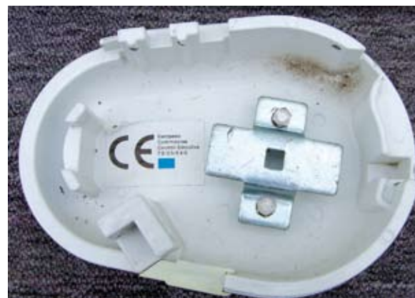
Sehr freie Interpretation des CE-Zeichens ohne Herstellerangabe und Windklasse.
